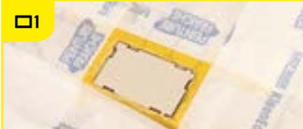
Используйте маскировочную ленту для моделизма, чтобы скрыть мелкие детали и сложный рельеф. Для более обширных площадей используйте малярную ленту.
