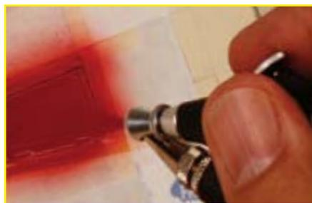
Аэрограф одинарного действия распыляет краску широким слоем. Это ограничивает его применение большими однотонными участками (например, панелями обшивки)
