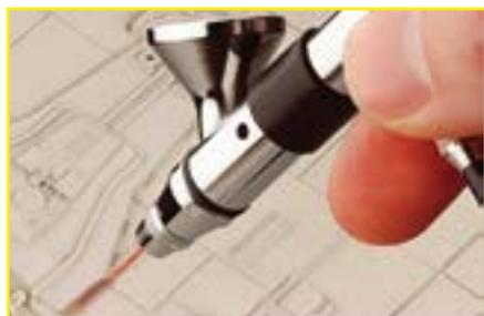
Аэрограф двойного действия дороже, но позволяет контролировать поток краски и работать над небольшими тонкими деталями, каких много на студийной модели
